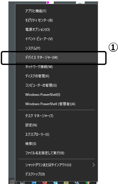
② デバイスマネージャーにて、シリアル変換ケーブルに警告アイコンがついているか確認します。
